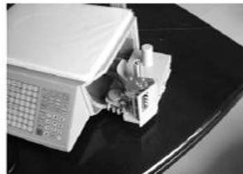
Figura 7. Apertura del módulo de impresión.
