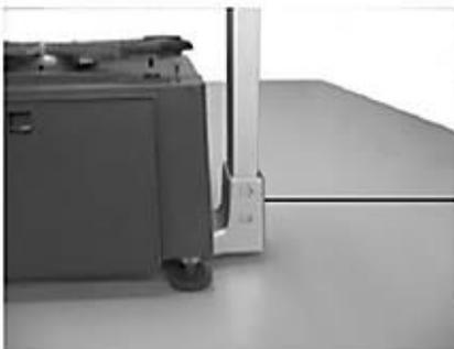
Atornille el poste a la base de la balanza por los orificios laterales
